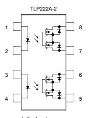
1, 3 : Anode 2, 4 : Cathode 5 : Drain D1 6 : Drain D2 7 : Drain D3 8 : Drain D4 Unit: mm
